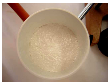
Récupération de l'acide benzoïque après filtration sur büchner.
