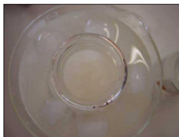
Après ajout de quelques mL d'acide chlorhydrique concentré ( 5 \text{ mol.L}^{-1} ), l'acide benzoïque cristallise
