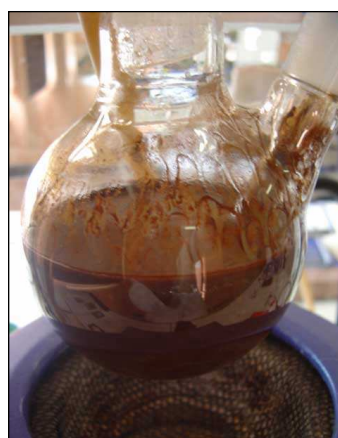
Après ajout de quelques mL d'éthanol par l'ampoule de coulée, la colorée violette disparaît: les ions \text{MnO}_4^- en excès sont réduits par l'éthanol
