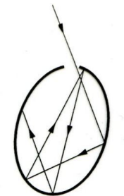
Enceinte noire, piège à rayonnement.
