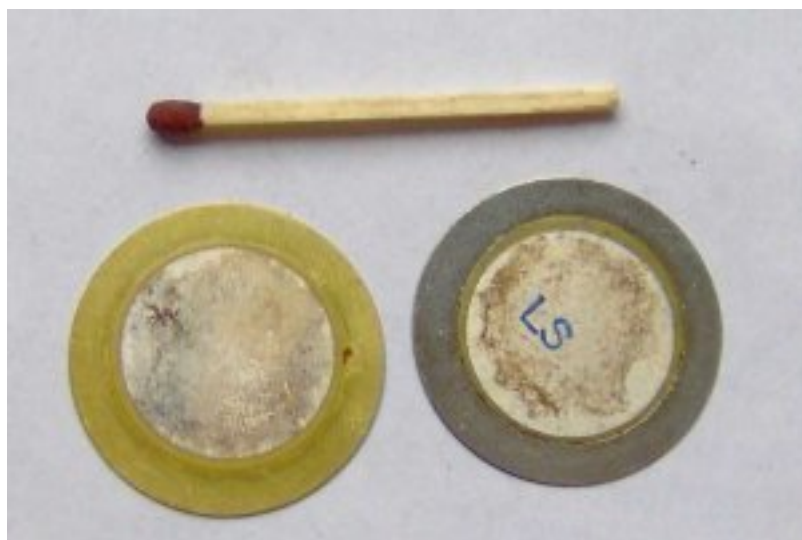
Figure : Éléments piézoélectriques de montre - (CC-BY-SA, FDominec)
