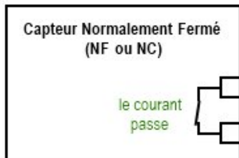
Figure 6.9 – Schéma d'un capteur normalement fermé
