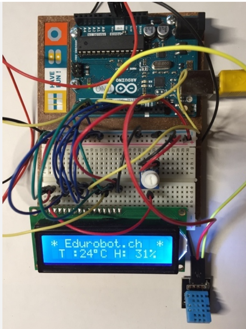
En bas à droite, de couleur bleue, le capteur DHT11, au-dessus l'afficheur LCD de deux lignes de 16 caractères qui indique la température et l'humidité actuelle. On remarque aussi un potentiomètre (résistance variable) sur la partie droite du breadboard dont le rôle est de régler la luminosité de l'écran.
