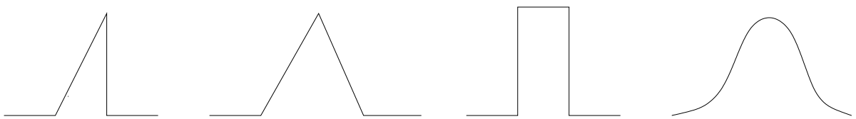
FIGURE 1.1 – Représentation schématique d’ondes transversales vues de profil.
