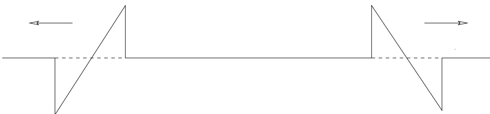
FIGURE 2.8 – Forme de la corde aux instants ultérieurs, t > 0 .
